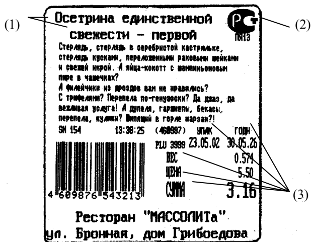
Рис. 7. Пример печати этикетки формата 9. Этикетка размером 58 x 60 мм, без препринта. (1) – две строки наименования товара; (2) – логотип; (3) – надписи “ВЕС”, “ЦЕНА”, “СУММА”, “УПАК”, “ГОДН” печатаются принтером весов.
