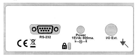
Задняя панель весов имеет разъем порта RS-232 и гнездо электропитания. Необходимое электропитание прибора - 15В при 800mA.
